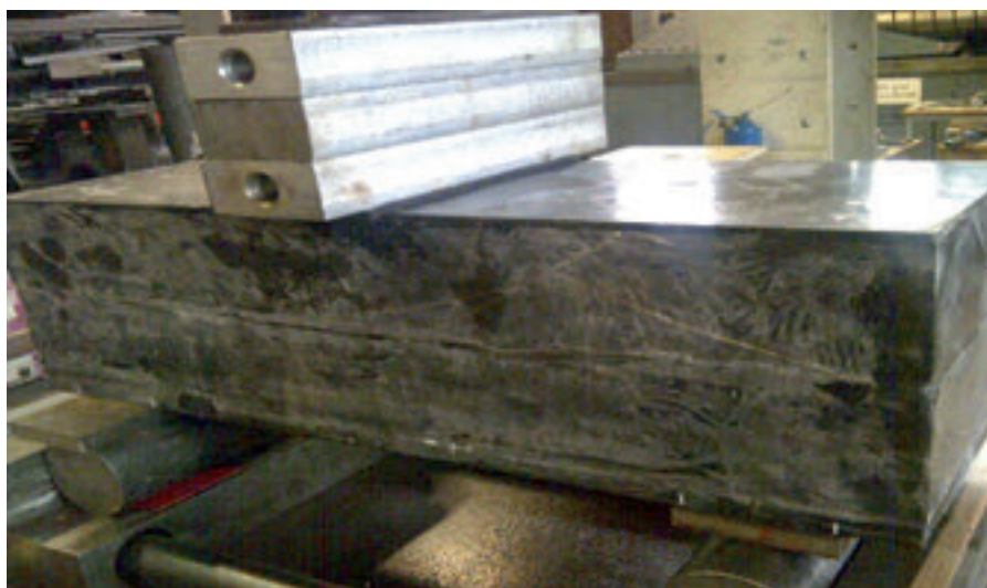
Indestructible en fatigue : aucune fissure à 10 millions de cycles / rupture de la pièce en béton à 3 millions de cycles.
