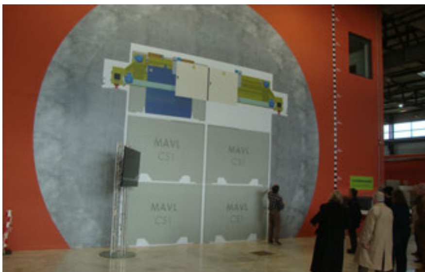
Visuel taille réelle d'une alvéole de stockage qui sera creusée à 500 m de profondeur pour accueillir les déchets de moyenne activité à vie longue (MA-VL).
