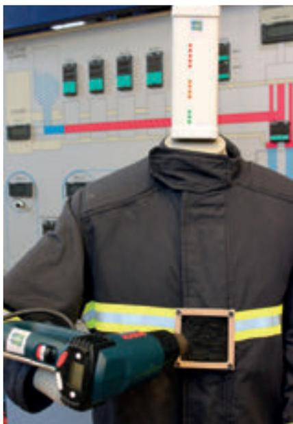
Mannequin instrumenté portant un tricot capteur thermique à base de fibres synthétiques chargées en nanotubes de carbone.
