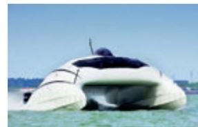
est plus petit, elle s'écroule, donc on réduit la vitesse.» Ce projet de navire deux fois plus rapide que les bateaux conventionnels, avançant à plus de 50 nœuds dans le milieu offshore, permet de diviser par deux la consommation de diesel.
