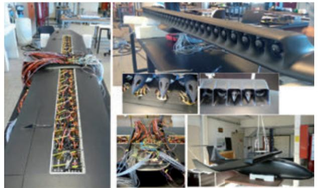
Fabrication de la maquette de soufflerie intégrant le système propulsif.
